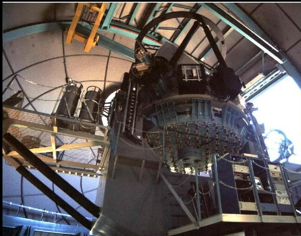
Duas visões do SOAR. Pode-se ver na esquerda a montagem altazimutal e na direita suporte do espelho primário
