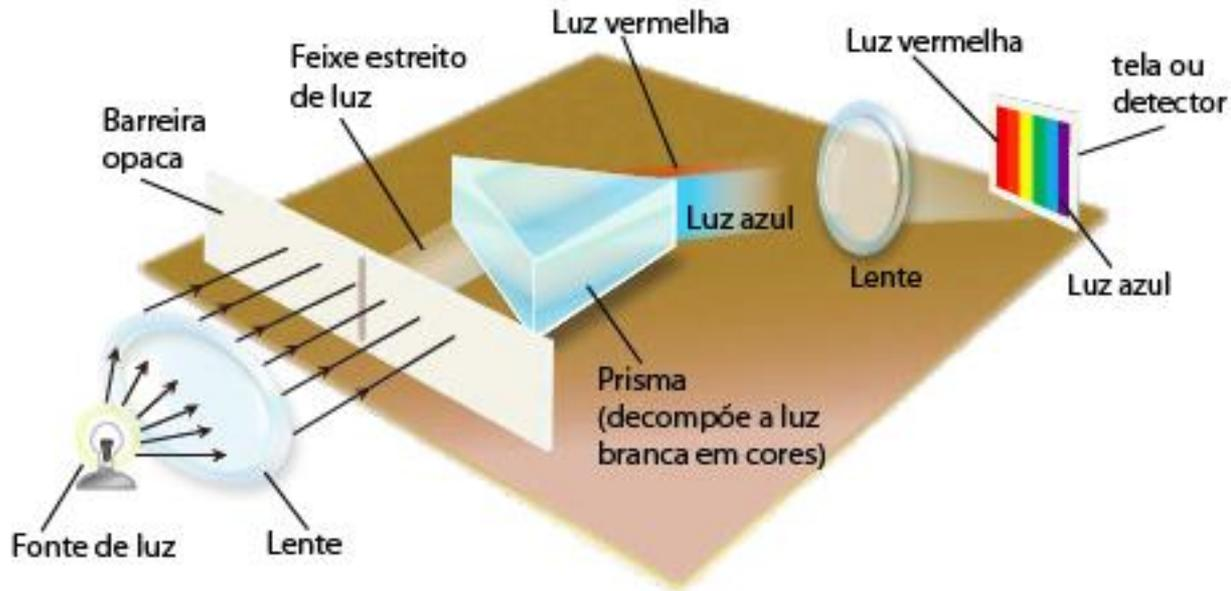
5- Esquema básico de um espectrógrafo (crédito: Chaisson & McMillan).
