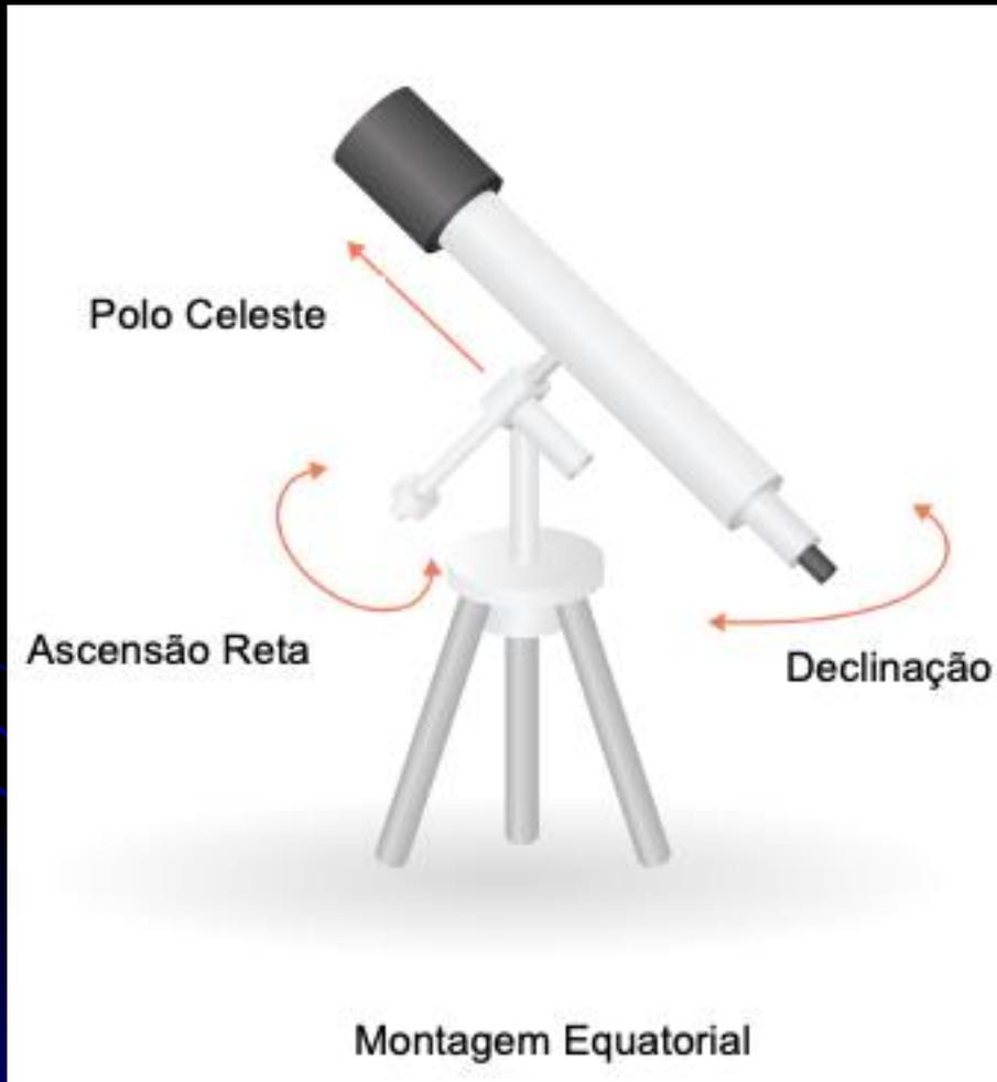
O Telescópio é montado num eixo perpendicular ao eixo da terra e em outro ortogonal a este. A rotação sobre o eixo da Terra dá o movimento N-S e sobre o outro eixo dá o movimento E-W.
