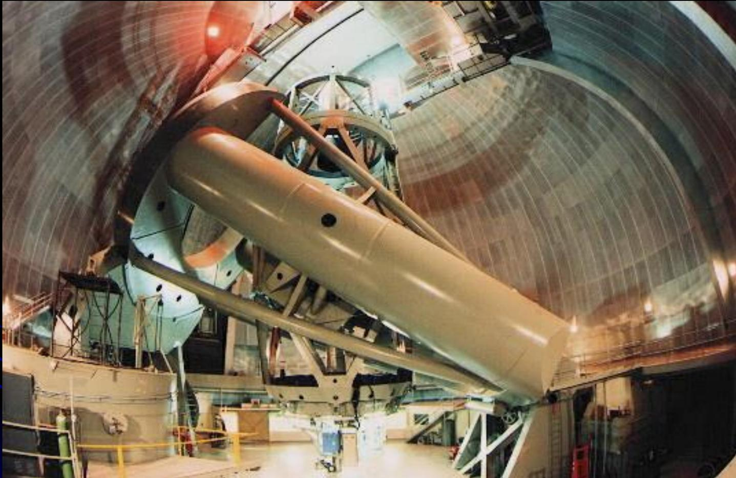
Montagem análoga a Mt. Wilson: equatorial em ferradura com dois pés. Até os anos 70 foi o maior telescópio do mundo. O telescópio russo de 6m construído nos anos 70 nunca funcionou direito e este aqui foi na prática o maior do mundo até a entrada em operação dos telescópios da classe de 8 m como o Gemini, VLT ou Keck.
