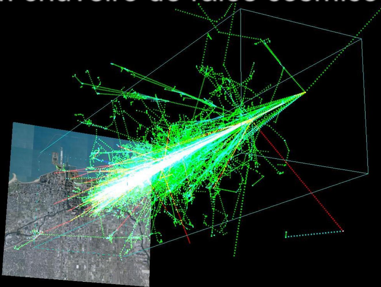
Um próton de altíssima energia chega na atmosfera superior e colide com diversas partículas que por sua vez colidem com outras, produzindo um “chuveiro” detectável do solo. Os detetores precisam ter milhares de  $\text{km}^2$
