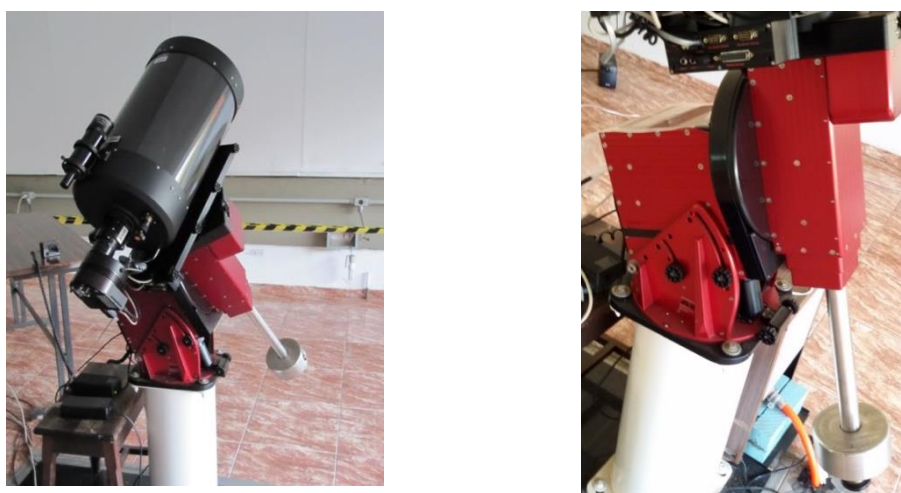
Figura I.1 –À esquerda Telescópio Argus do projeto TnE instalado no Observatório Abrahão de Moraes em Valinhos, à direita e plataforma de controle Paramount ME.
