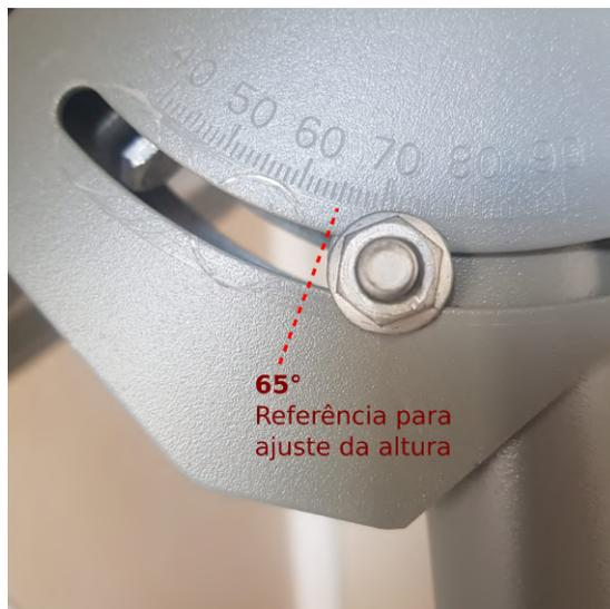
(a) Borda do parafuso como referência para ajuste da coordenada  $65^\circ$  de altura.
