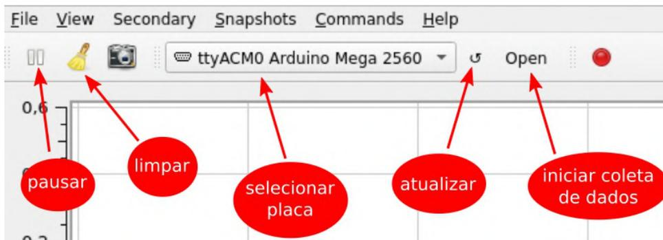
Figura 65 – Detalhe do software onde seleciona-se a placa de arduino e inicia-se a coleta de dados.
