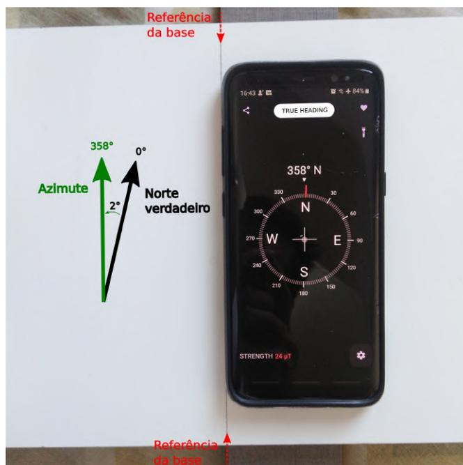
Figura 61 – *Smartphone* alinhado com o eixo de referência da base da antena. Créditos: Autor.
