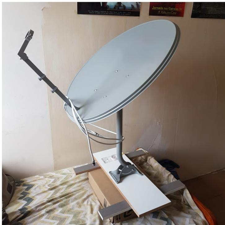
Figura 34 – Antena montada sem o LNB.
