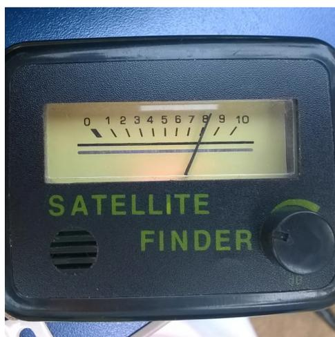
Figura 30 – Mostrador analógico do SatFinder utilizado para aferir a intensidade do sinal dos satélites alvo.
