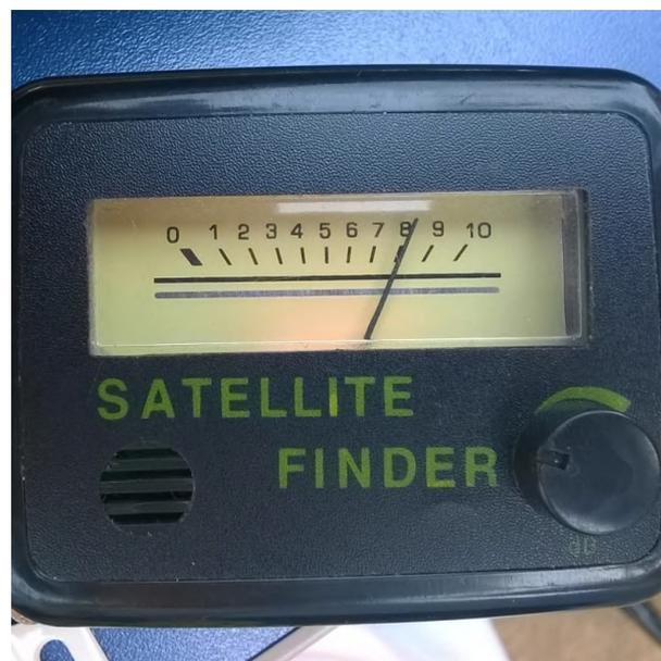
Figura 36 – Mostrador analógico do SatFinder utilizado para aferir a intensidade do sinal dos satélites alvo. Créditos: Autor.
