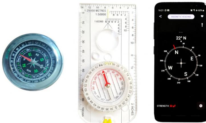
Figura 38 – Da esquerda para a direita, bússolas: de metal, de acrílico e smartphone. Créditos: Autor.
