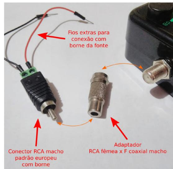
(b) Borne RCA padrão europeu (peça da esquerda) e adaptador metálico de conexão RCA-Coaxial (peça do meio).
