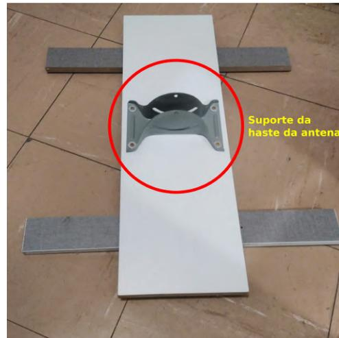
(b) Base montada e com suporte da haste fixado.
