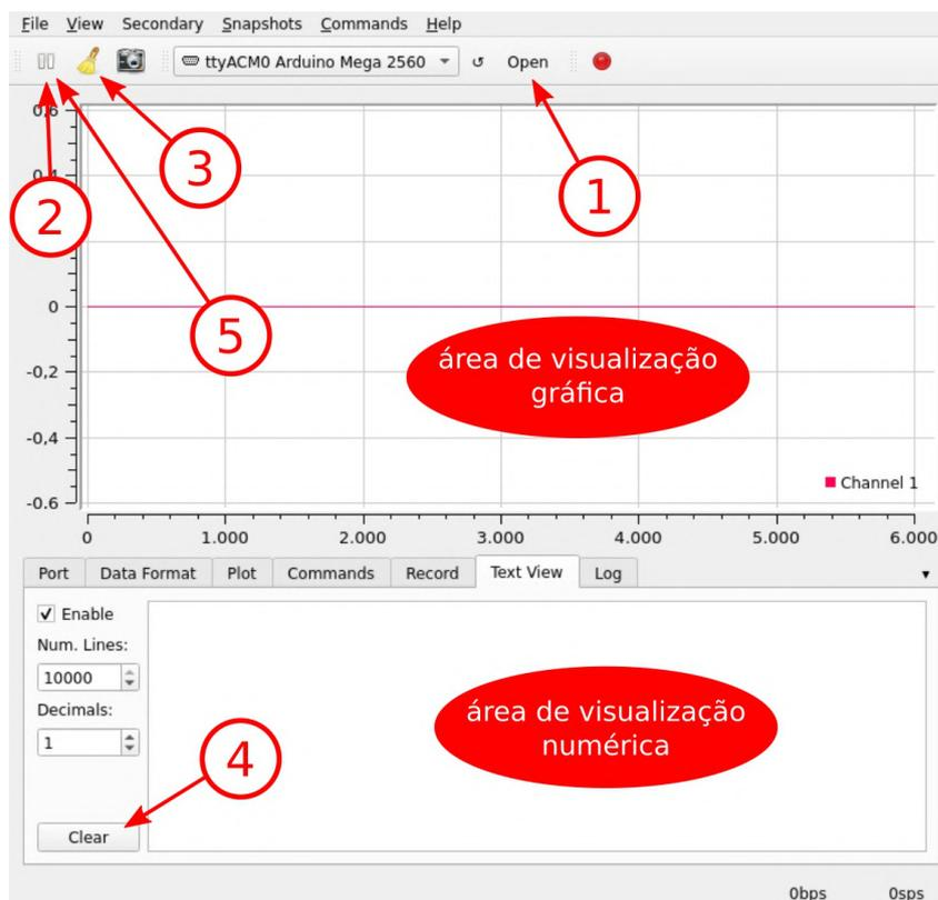
Figura 66 – Passo a passo enumerado para testar e iniciar a coleta de dados.
