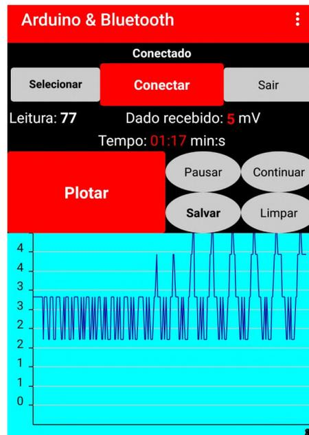
Figura 29 – Aplicativo para coleta de dados de arduino via bluetooth desenvolvido na plataforma AppInventor.
