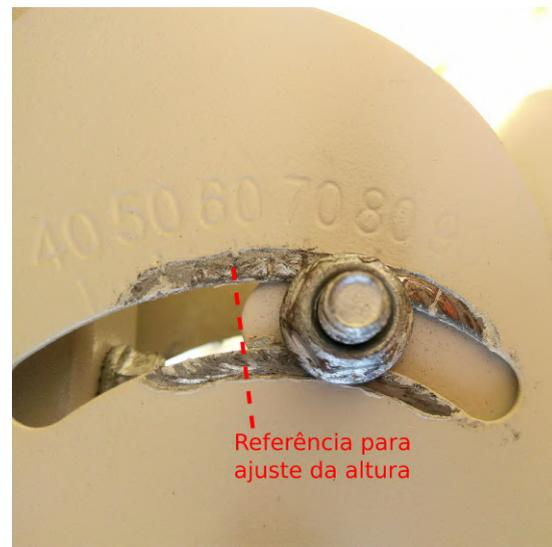
(b) Referência de ajuste para  $60^\circ$  em um segundo modelo de antena.
