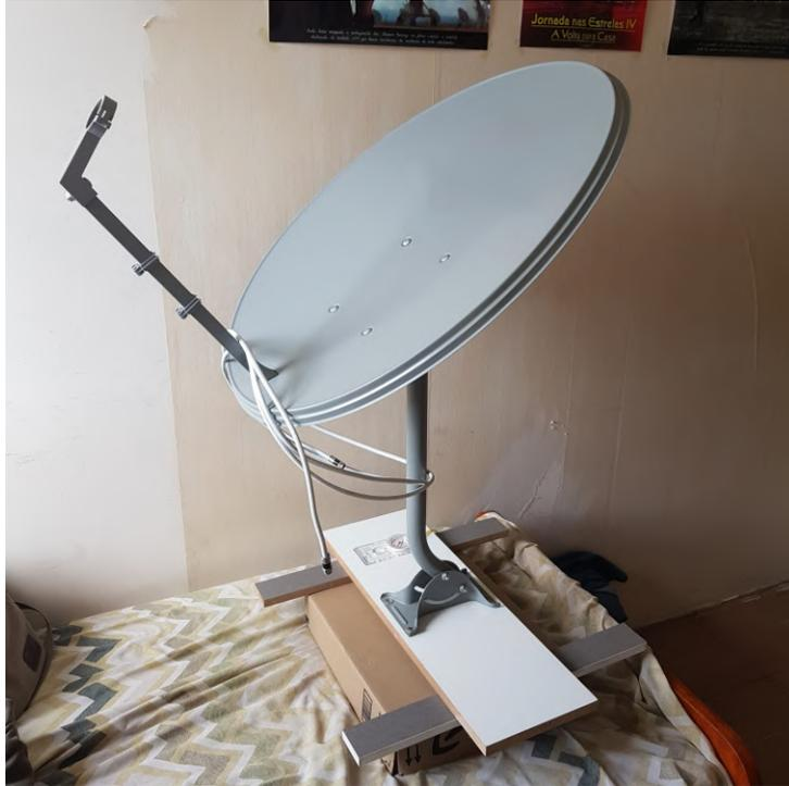
Figura 51 – Antena montada sem o LNB.
