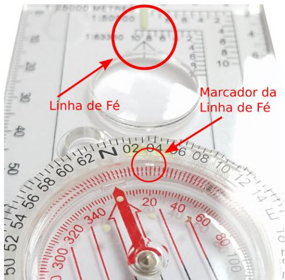
(a) Detalhe do ajuste da Escala de Declinação com a Linha de Fé.
