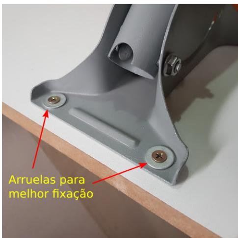
(a) Detalhe da fixação com arruelas do suporte da haste.
