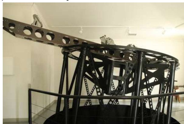
Figuras 151 e 152 - À esquerda vemos o esquema óptico do interferômetro instalado por Michelson no telescópio Hooker no Monte Wilson; à direita vemos um modelo em escala do aparato construído por Michelson para o interferômetro do Monte Wilson. Desenho e foto: Francisco Conte.
