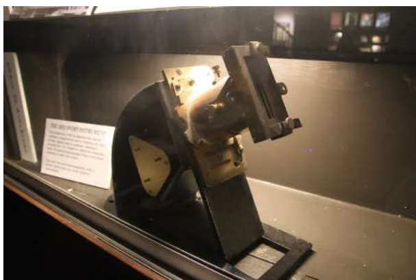
Figuras 53 e 54 - Instrumentos de espectroscopia utilizados por Vesto Slipher em Flagstaff para descobrir o grande desvio para o vermelho das linhas de absorção dos espectros de galáxias. Fotos: Francisco Conte.
