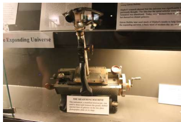
Figuras 53 e 54 - Instrumentos de espectroscopia utilizados por Vesto Slipher em Flagstaff para descobrir o grande desvio para o vermelho das linhas de absorção dos espectros de galáxias. Fotos: Francisco Conte.
