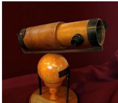
**Figura 5:** Réplica do telescópio de Newton. **Foto:** Dunn, A, 2004.
