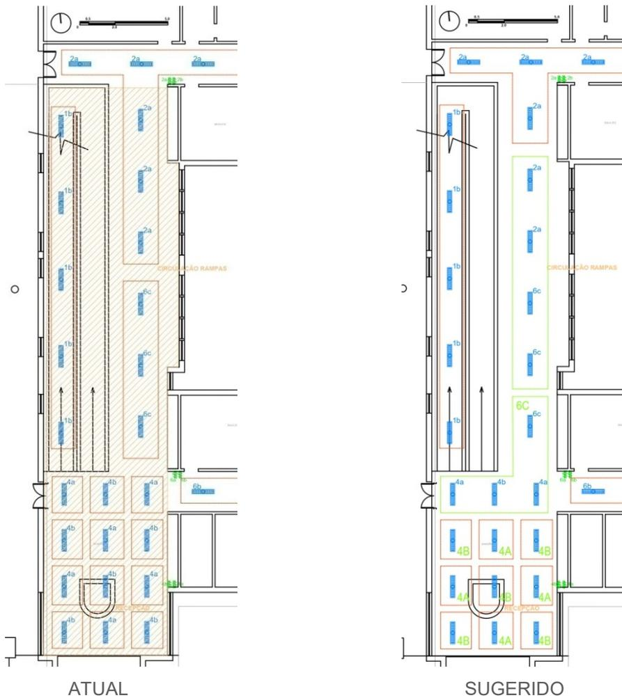
Figura 34: Planta de distribuição dos sistemas de acionamento e iluminação da circulação próxima às rampas no 1º pavimento. Fonte: Redesenho dos autores.
