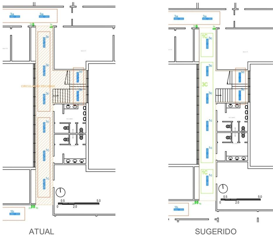
Figura 33: Planta de distribuição dos sistemas de acionamento e iluminação da circulação próxima às escadas no pavimento térreo. Fonte: Redesenho dos autores.
