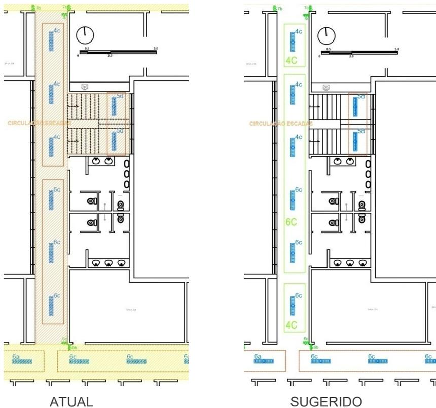
Figura 38: Planta de distribuição dos sistemas de acionamento e iluminação da circulação próxima às escadas no 2º pavimento. Fonte: Redesenho dos autores.
