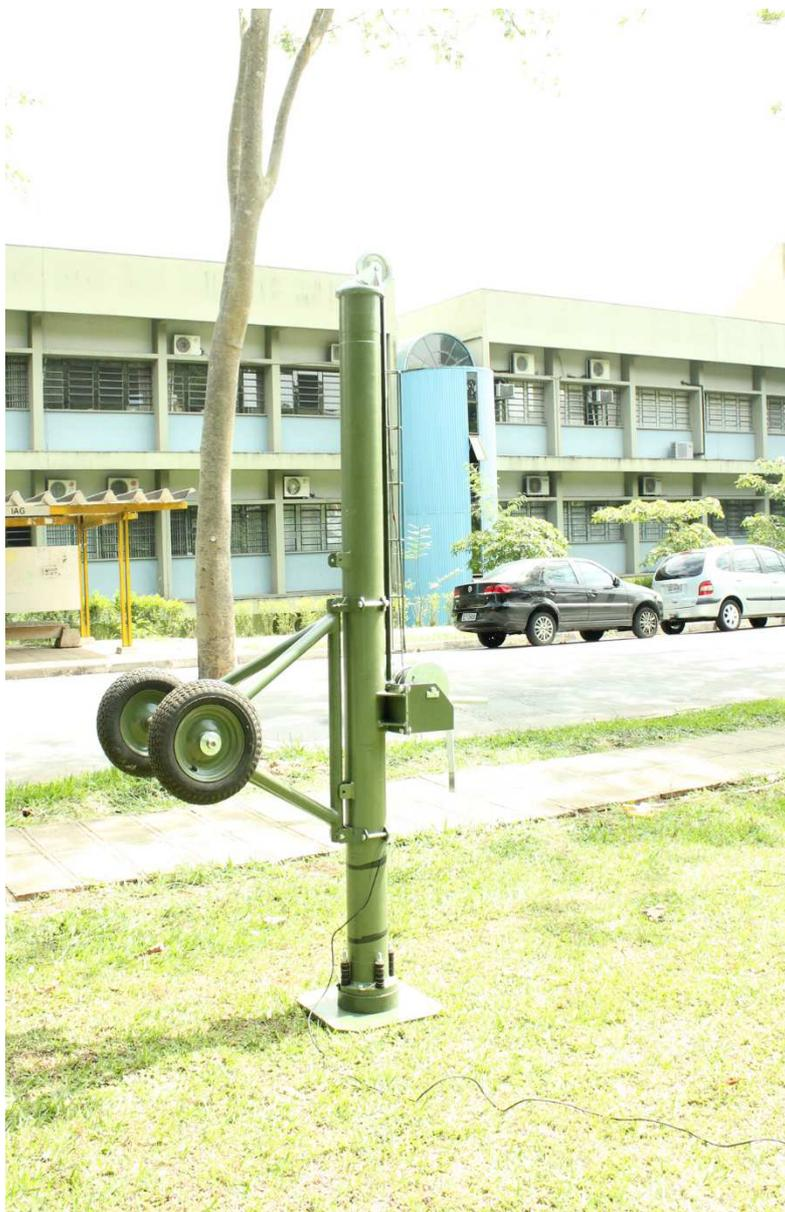
Figura 6.2: Vista da fonte queda de peso empregada em uma das etapas dos ensaios MASW.
