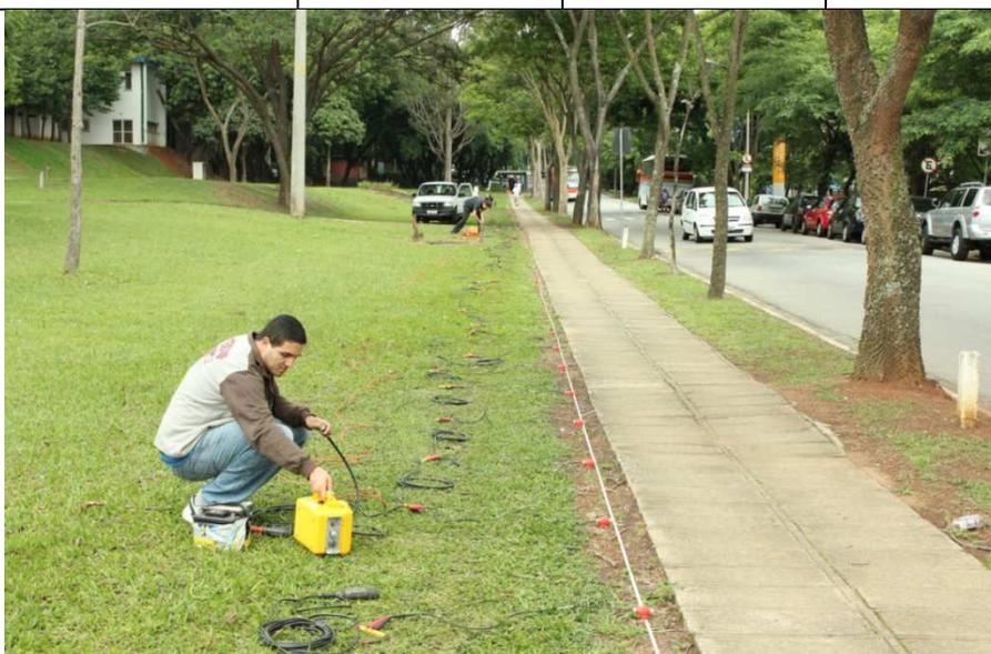
Figura 6.3: Montagem dos equipamentos para a aquisição de dados empregando o método MASW.
