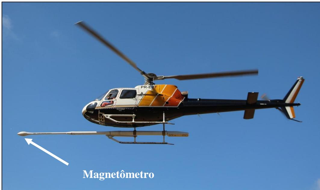
Figura 20: Helicóptero utilizado durante a aquisição de dados no aerolevante HeliMAG.
