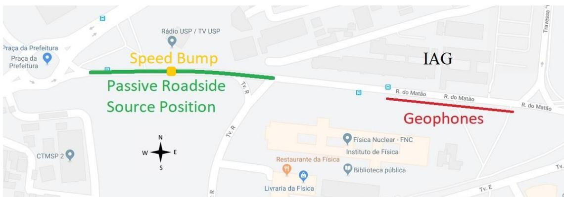
Figura 54 - Mapa do local da aquisição *Passive Roadside MASW* com posição dos lugares de geração de ondas e arranjo de geofones.
