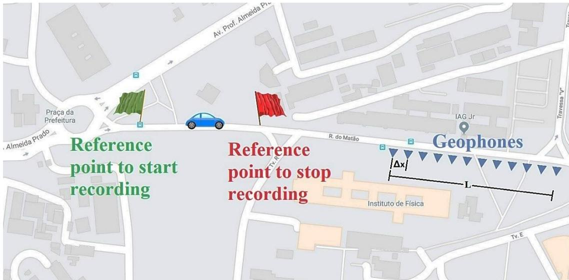
**Figura 32** - Exemplo de arranjo de campo para aquisições *Roadside Passive MASW*, onde  $\Delta x$  é o espaçamento entre geofones e  $L$  o comprimento do arranjo (Google Maps).
