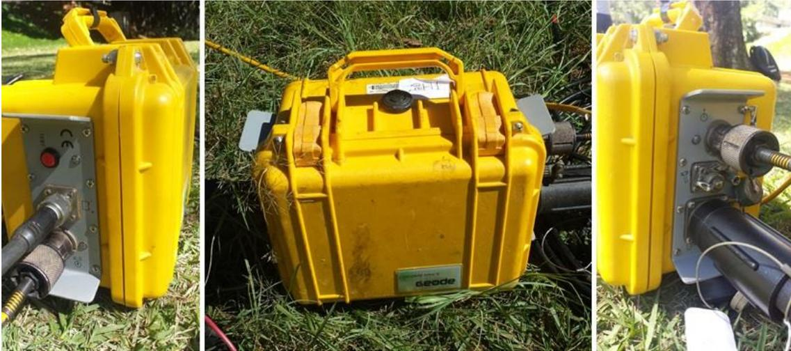
**Figura 17** - Sismógrafo Geometrics Geode de 24 canais.
