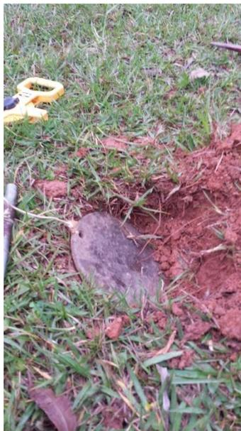
**Figura 22** - Base de impacto em posição inclinada para geração de ondas Love, além de ondas Rayleigh.
