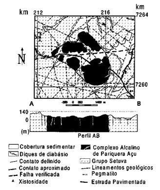
Figura 3 - Mapa geológico local do complexo alcalino de Pariquera-Açu (modificado de Ferreira et al. 1987).
