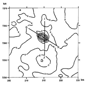
Figura 6 - Mapa residual Bouguer (polinômio robusto de grau 6), observa-se a pasição dos perfis, GH e II ao longo dos quais foram realizados os modelos 2,5D.
