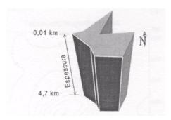
Figura 10 - Modelo 3 D do complexo alcalino de Pariquera-Açu através de um prisma de seção poligonal. O modelo se ajusta aos parâmetros físicos do complexo alcalino. O prisma foi obtido através do programa "GPCYLNIN".
