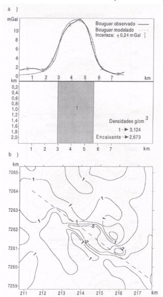
Figura 12 - (a) Perfil para o modelo 2,5 D do paralelepípedo oblíquo, a linha contínua representa o sinal observado e a pontilhada representa aquele modelado; (b) mapa residual (observado - modelo); a linha tracejada indica a posição do perfil em (a).
