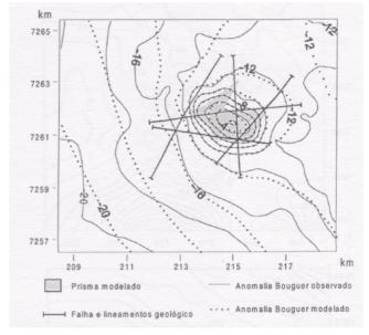
Figura 9 - Mapa da anomalia Bouguer: as curvas sólidas correspondem às isolinhas do campo anômalo observado e aquelas tracejadas às do campo anômalo modelado. O poligono de cor cinza representa a seção horizontal do prisma modelado com contraste de densidade de 0.4 g/cm³, profinidade do topo de 0.01 km e base de 4.7 km. Os segmentos de retas com terminações ortogonais indicam as direções da falha e dos lineamentos geológicos.
