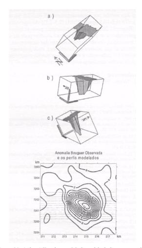
Figura 16 - (a, b e c) Visualização 3 D do modelo de formato irregular para o complexo alcalino de Pariquera-Açu por três ângulos diferentes.
