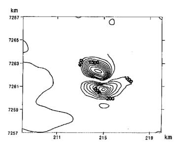
Figura 1 - Anomalia magnética em correspondência ao complexo alcalino de Pariquera-Açu. (dados aéreos cedidos pela CPRM).
