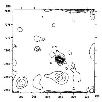
Figura 5 - representação do resíduo do polinômio robusto de grau 6 calculado a partir dos dados do levantamento gravimétrico.
