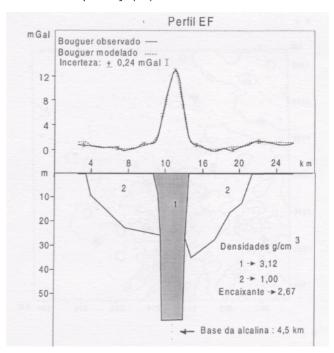
Figura 8 - Modelo 2.5 D da auréola negativa localizada ao redor do complexo alcalino, obtido a partir do mapa anômalo Bouguer através da solução de mínimos quadrados de grau 6. O modelo do corpo 2 foi extrapolado para uma situação hipotética onde existe apenas água.
