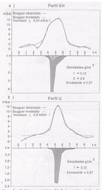
Figura 7 - Modelagem gravimétrica 2,5 D do complexo alcalino de Pariquera-Açu. A base do corpo modelado está a uma profundidade de 4,5 km da superfície, para o perfil (a) GH e (b) 2,35 para o perfil IJ.
