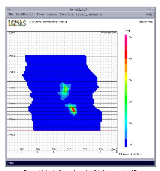
Figura 10.11. isolinhas de profundidade do modelo 3D
