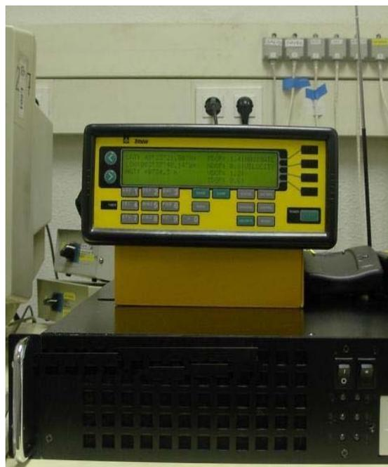
b) Receptor GPS *TRIMBLE 4000SSI*
