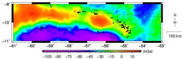
Figura 5 – Residual da Anomalia Bouguer para a região da província de Alta Floresta. Os pontos correspondem à localização das minas exploratórias da província.
