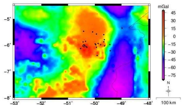
Figura 4 – Residual da Anomalia Bouguer para a região da província de Carajás. Os pontos correspondem à localização das minas exploratórias da província.
