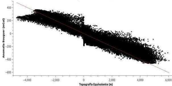
Figura 1 – Ajuste pelo MMQ dos dados de anomalia Bouguer em função dos dados de topografia equivalente.
