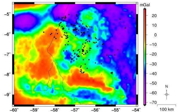
Figura 3 – Residual da Anomalia Bouguer para a região da província de Tapajós. Os pontos correspondem à localização das minas exploratórias da província.
