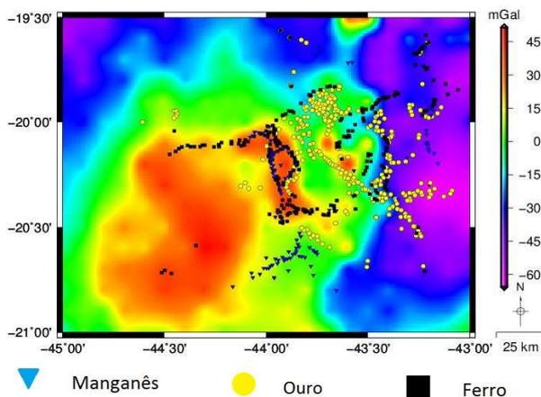
Figura 6 – Residual da Anomalia Bouguer para a região da província do Quadrilátero Ferrífero. Os pontos correspondem à localização das minas exploratórias da província: preto correspondem às minas de ferro; azul às de manganês e amarelo às de ouro.
